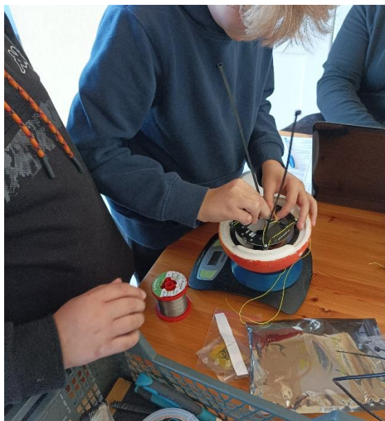
Obr. č. 9: Protážení provázků na uchycení balónu
